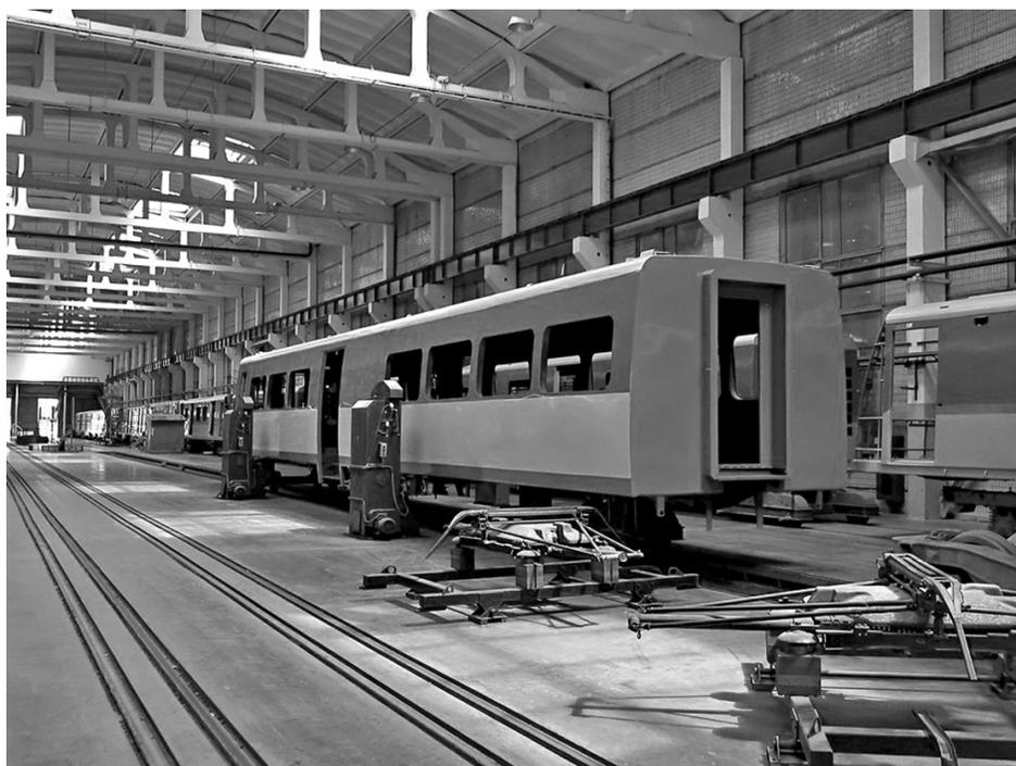
Сборка вагонов рельсового автобуса на домкратах и технологических тележках
